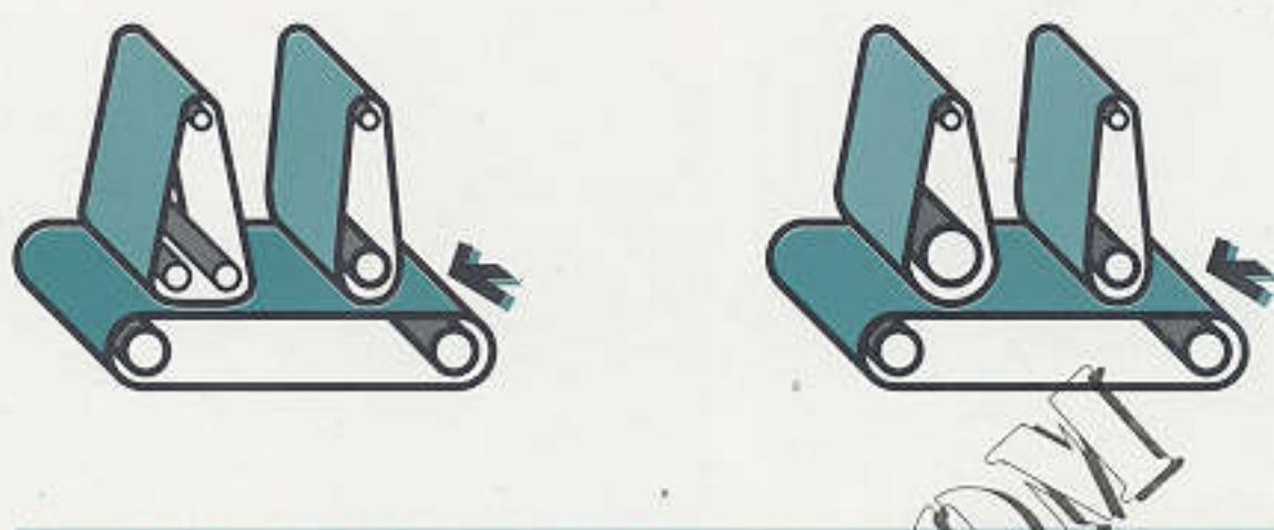
Calibratrice levigatrice con 1 motore e 2 nastri 2200 mm.
