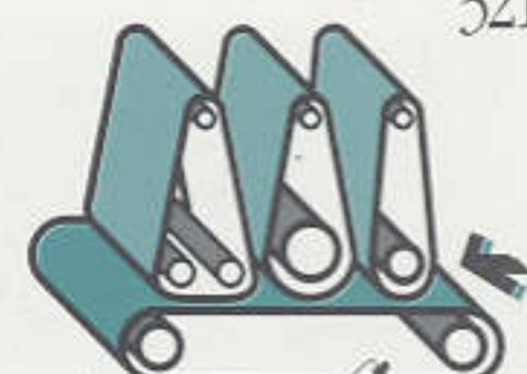
Calibratrice levigatrice a 3 nastri, composta da 2 rulli e 1 tampone per massiccio, truciolare, tamburato, imballacciatura, vernice.
